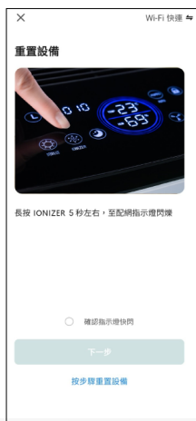
8.長按五秒“IONIZER”鍵，直到顯示WIFI符號閃爍，啟動📶模式
